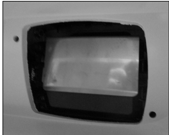
FIG.5 SÉRIE H3 - PLAQUETTE MÉTALLIQUE DE MONTAGE POSÉE SUR LE CAPTEUR RADAR
