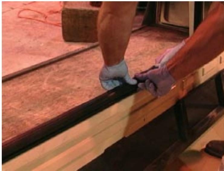
9. Asperger le joint de caoutchouc d'eau savonneuse pour faciliter l'insertion du pare-brise.
