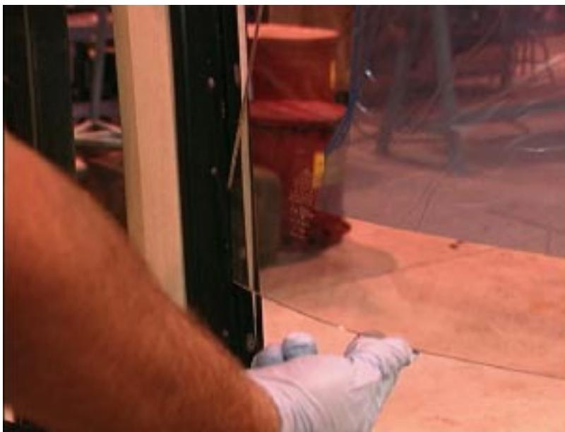
11. Enlever le surplus de produit d'étanchéité avec un chiffon Chix (Prévost # 682384) imbibé de nettoyeur Sika 205.
