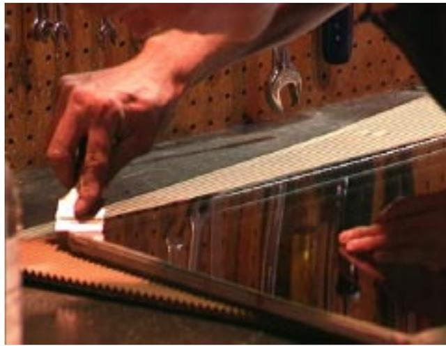
3. Nettoyer le côté de la fenêtre qui sera appuyé contre le produit d'étanchéité Sika 255 (Prévoist # 681092) avec le nettoyeur Sika 205 sans faire de mouvement de va-et-vient. Laisser sécher pendant 5 minutes.
