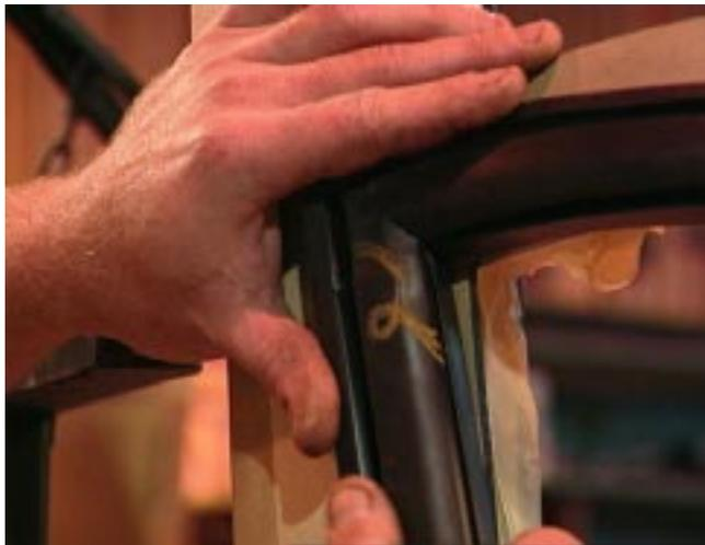
4. Nettoyer le pare-brise et le cadre de la section de pare-brise avec du nettoyeur Sika 205 (Prévost # 683097) et laisser sécher de 1 à 2 minutes.
