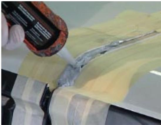
6. Utiliser la lame de plastique (Prévost # 682838) pour enlever l'excédant de produit d'étanchéité, appliquer une deuxième couche si nécessaire et réutiliser la lame pour obtenir une finition aussi lisse que possible.
