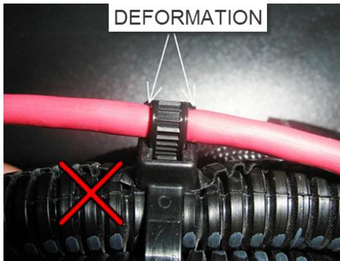
Serrage excessif de l'attache de nylon sur le LTD. Serrer la boucle du LTD à la main seulement. Effectuer le serrage nécessaire pour éviter que le LTD puisse glisser dans la boucle sans plus.
