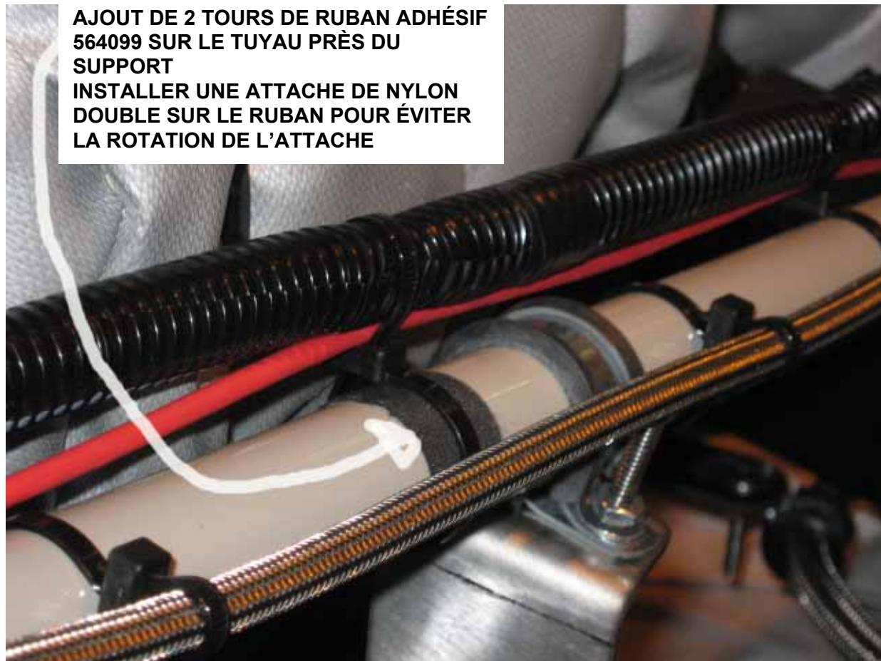
Sur le coté alternateur ou admission du moteur, réacheminer le détecteur thermique linéaire (câble rouge) pour éviter le contact et l'usure avec le collier. Refixer selon la photo.
