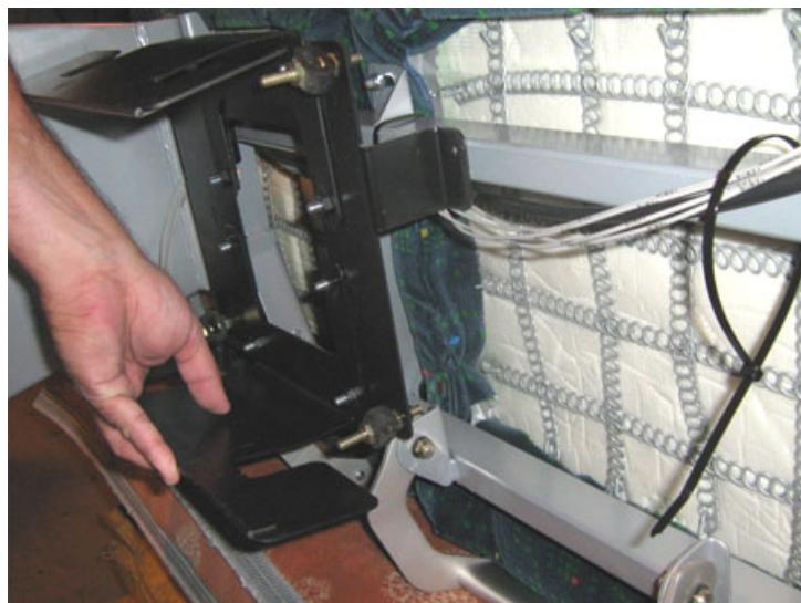
Utiliser une mèche Ø No.14 (0.182 po) et percer 4 trous.
