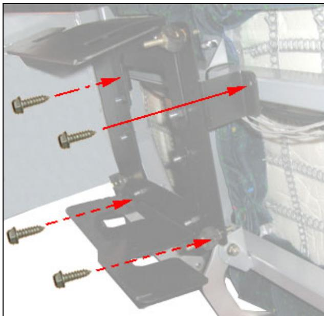
Placer le caisson sur le support de fixation.
