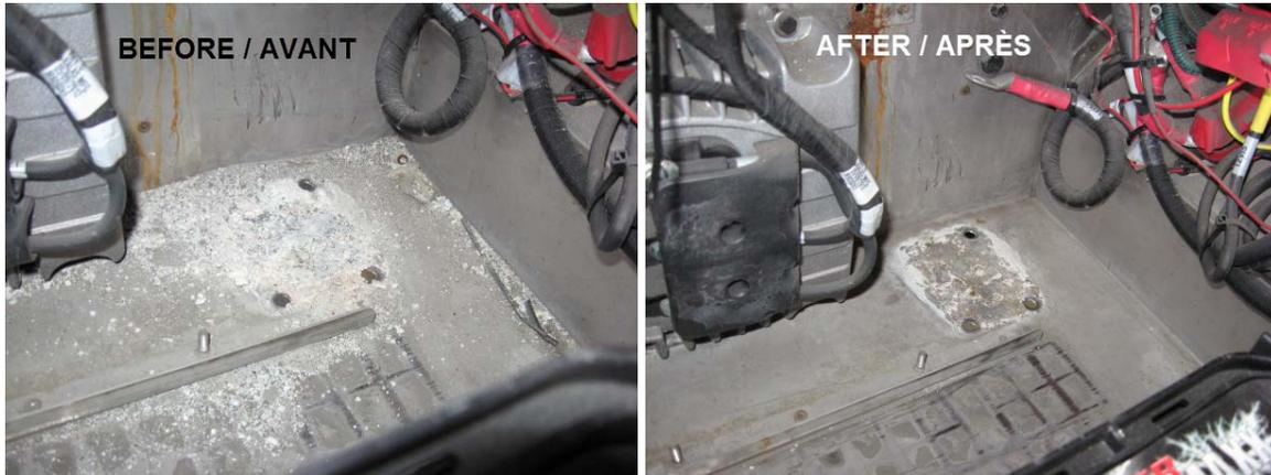
12. À l'aide d'un assistant, installer les 3 nouveaux boulons de 30mm de long par le dessous du véhicule et les 6 rondelles plates en acier inoxydable par le dessus.
