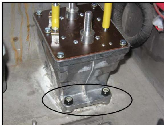
14. Serrer les 3 écrous pour fixer le relais solidement au fond de la boîte à batterie.
