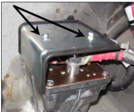
19. Remettre la batterie arrière droite en place (pole négatif - à gauche, positif + à droite).
