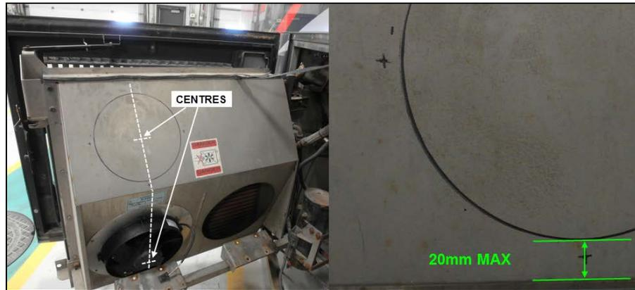
12. Découper l'ouverture du ventilateur supérieur à l'aide d'un outil de coupe rotatif.
