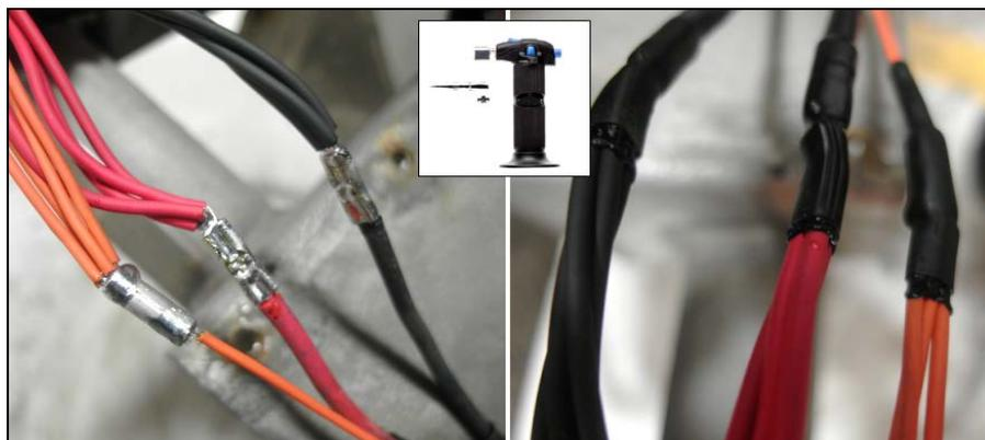
14. Raccorder les quatre ventilateurs aux nouveaux connecteurs (les ventilateurs peuvent être raccordés à n'importe quel connecteur, les connecteurs étant interchangeables). Ajouter des attaches de câble (**504637**) si nécessaire pour fixer les harnais à la structure de la porte.
