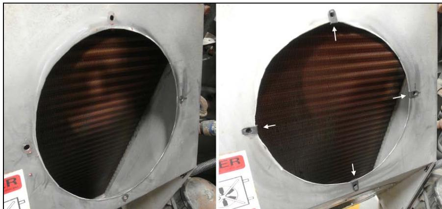
23. Placer un ventilateur sur l'ouverture en s'assurant que le faisceau de câbles du ventilateur est orienté vers le centre du carénage. Fixer le ventilateur sur le carénage à l'aide des boulons et des écrous fournis.
