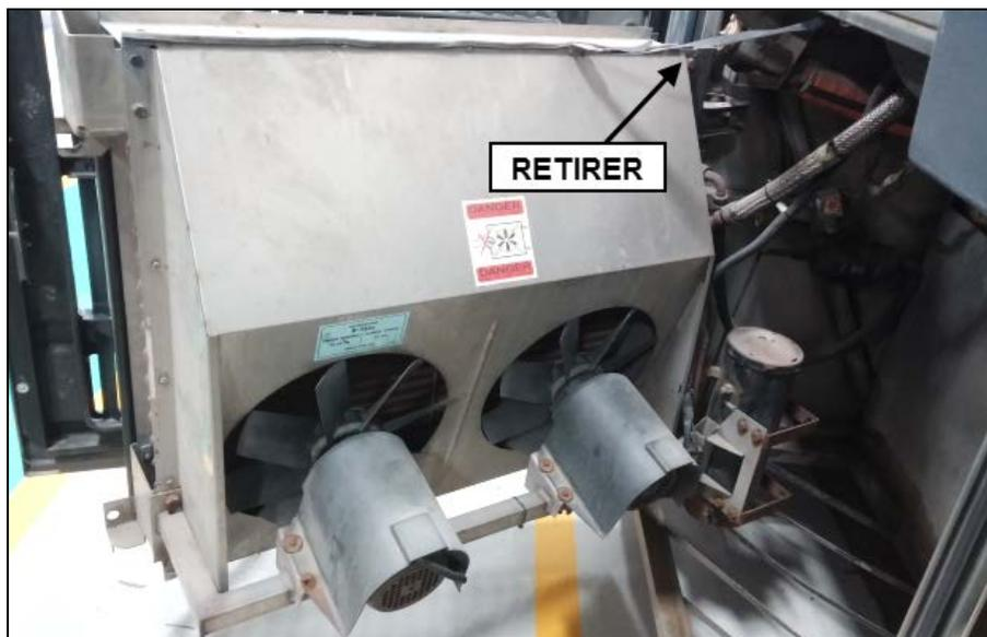
2. Enlever le support de sangle de retenue fixé sur le carénage (percer le centre des rivets).
