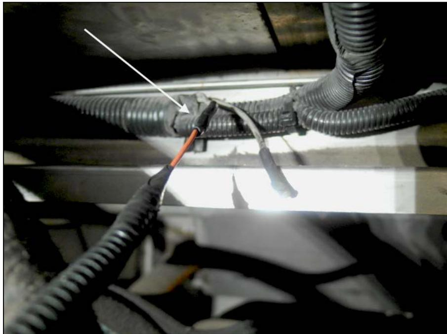
10. Acheminer le fil orange le long du harnais principal de ventilateur et du harnais de ventilateur n°2 (long). Fixer au harnais à l'aide des attaches fournies **504637**.
