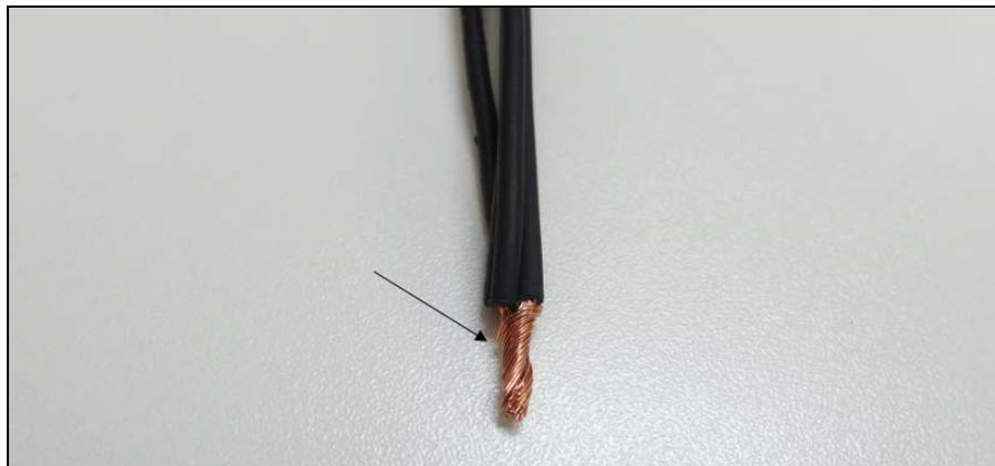
4. Sertir un connecteur bout-à-bout **562233** de calibre 12-10 à chaque extrémité torsadée des faisceaux.
