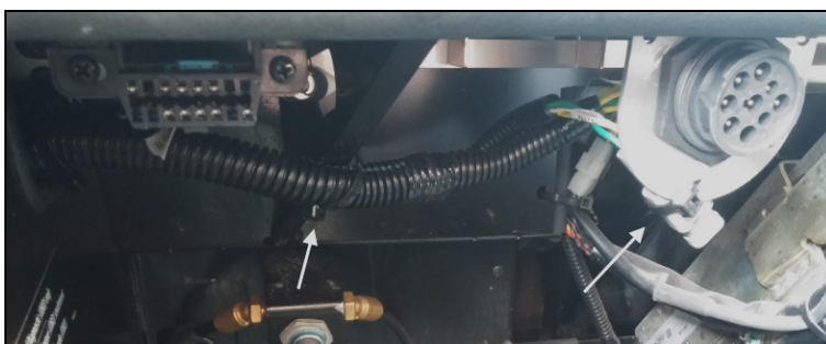
FIXER LE HARNAIS SOUS LE TABLEAU DE BORD
