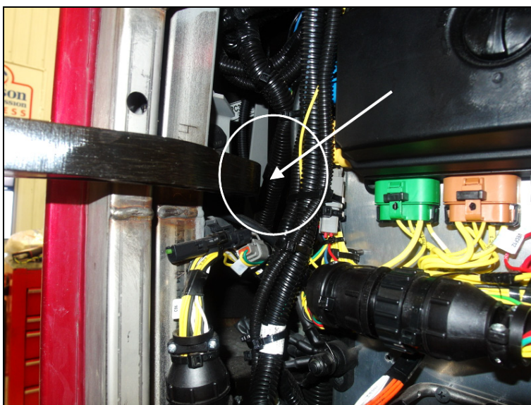
EVITER TOUT CONTACT HARNAIS/PENTURE (H3 MONTRE)
