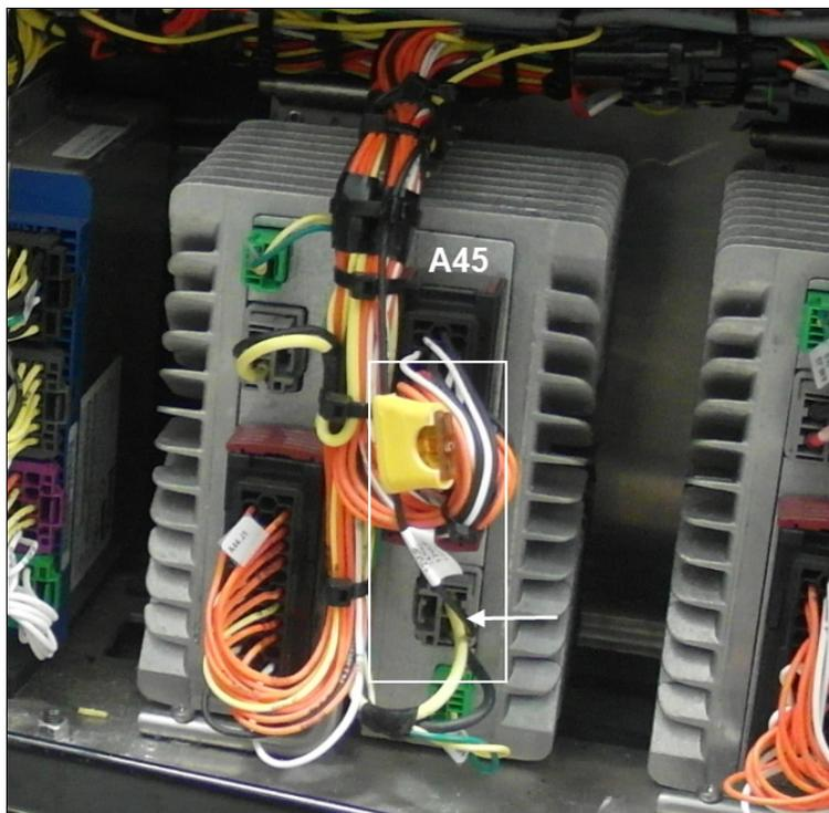
**A45 MODULE & ELD GATEWAY MODULE CONNECTION**
