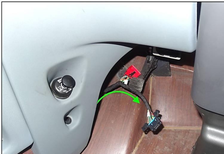
5. Brancher le connecteur OBD du véhicule (celui précédemment retiré du support) au connecteur rouge du harnais.
