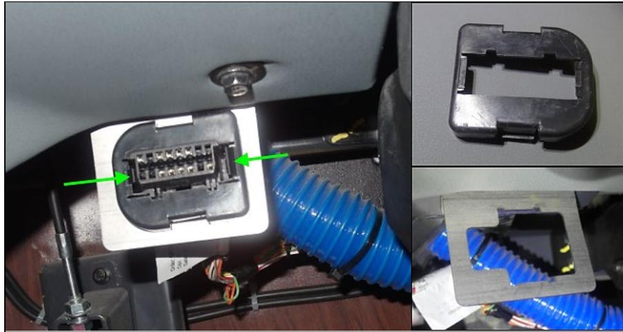
4. Passer le harnais d'interface 23446648 du compartiment électrique vers l'emplacement du connecteur OBD sous le tableau de bord.
