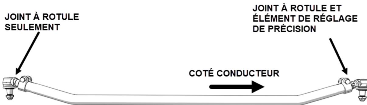
FIGURE 6 : BIELLE DE LIAISON - 2 DIFFÉRENTS TYPES D'AJUSTEMENT DE JOINT À ROTULE
