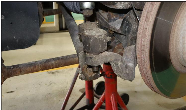
FIGURE 4: ENLÈVEMENT DE LA TIGE DU JOINT À ROTULE.
