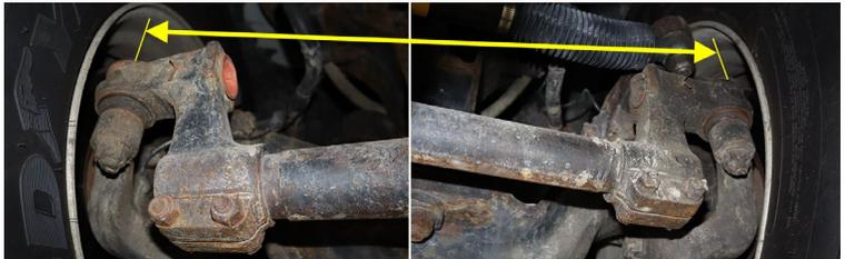
FIGURE 3: MESURE CENTRE EN CENTRE DES JOINTS
