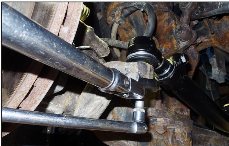
FIGURE 11: SERRAGE DU JOINT À ROTULE
