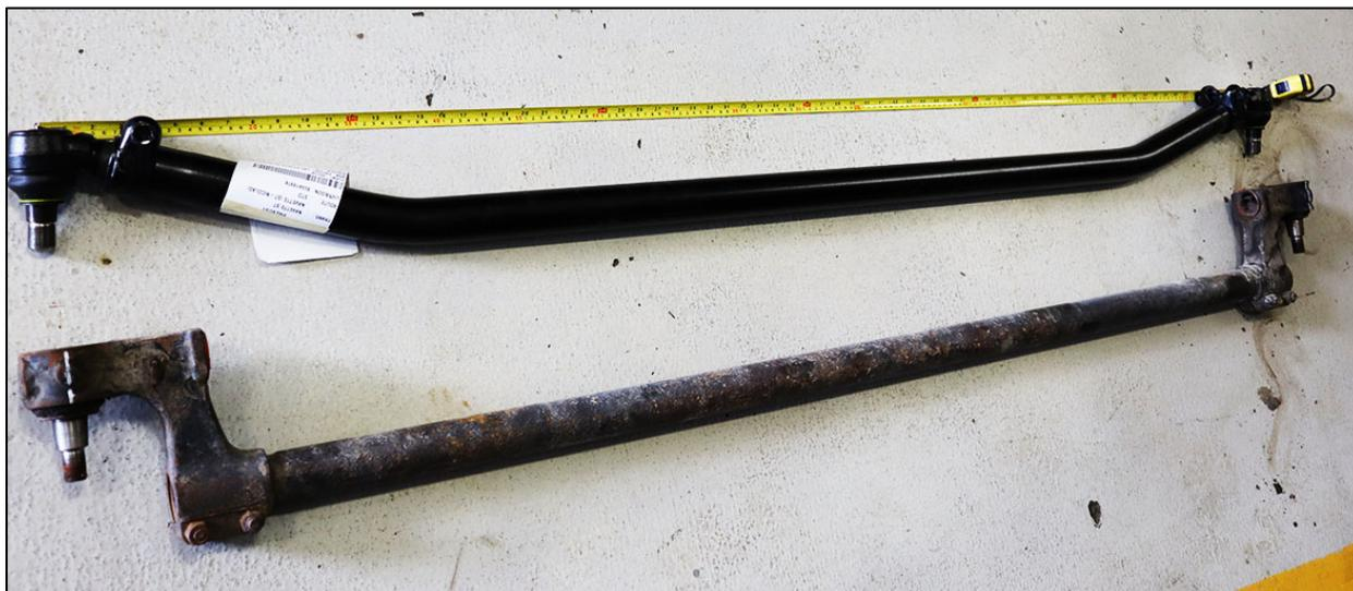
FIGURE 1: ANCIENNE ET NOUVELLE BIELLE DE LIAISON AU-DESSUS
