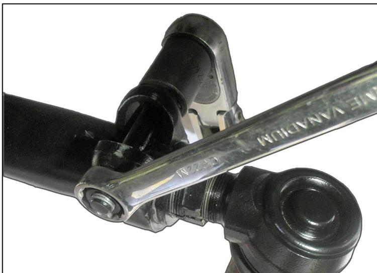
FIGURE 13: SERRAGE DU COLLIER DE BLOCAGE
