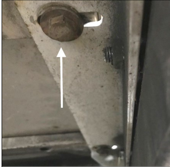
FIGURE 14: VIS DU SUPPORT DE BATTERIES (3X EN DESSOUS)
