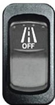
INTERRUPTEUR D'ACTIVATION/DÉSACTIVATION DE LA FONCTION D'AVERTISSEMENT DE SORTIE DE VOIE LDW
