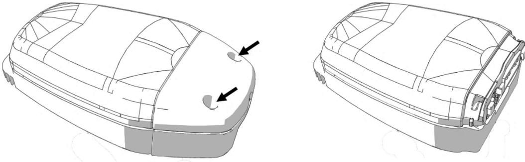
2. De chaque côté de la caméra, insérez un petit tournevis à lame plate dans l'ouverture.
