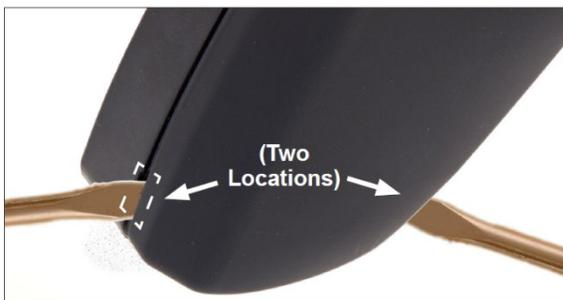
3. Soulevez doucement les poignées de tournevis en les éloignant du pare-brise - pousser contre les clips de rétention pour libérer la caméra (voir l'image ci-dessous avec la caméra cachée pour montrer le mécanisme).
