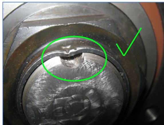
Figure 30: CORRECT – EMPÊCHE L'ÉCROU DE SE DESSERRER
