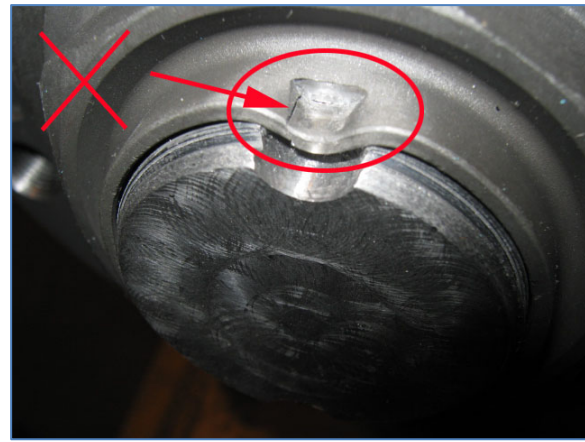
Figure 32: EMBOSSEMENT FISSURÉ OU DÉCHIRÉ – REJETER
