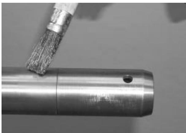
Figure 25: APPLIQUER LA GRAISSE GLEITMO 805
