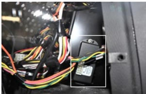
7. À l'aide de l'outil d'extraction **681485**, retirer le terminal situé à la position 2 (fil A55RJ1.18) du connecteur du module A139.
