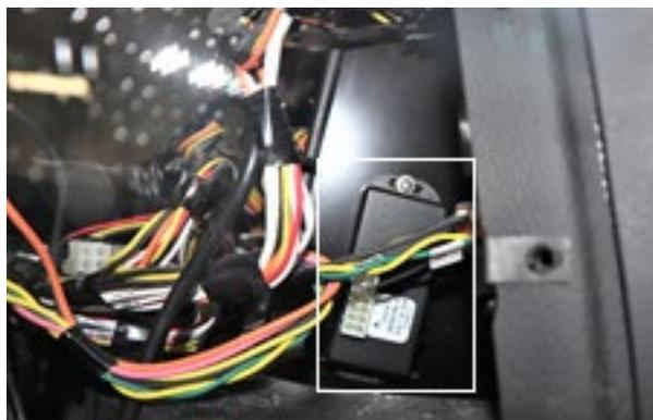
22. Acheminer le fil noir de 36" préalablement préparé du connecteur A139 au connecteur A103 (passer à travers le tableau de bord près de la colonne de direction).
