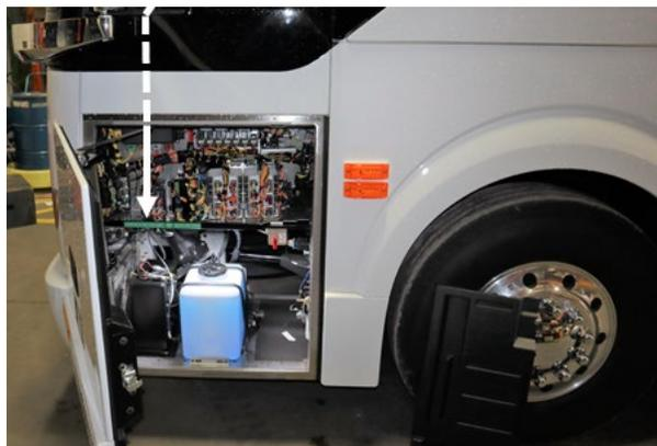
13. Brancher le terminal rond du fil à l'une des vis de mise à la masse (ground) de la boîte de jonction avant.
