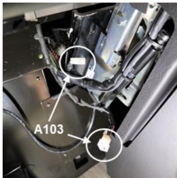
18. À l'aide de l'outil d'extraction **681485**, retirer le fil de mise à la masse (ground) **00A** situé à la position 4 du connecteur A103.
