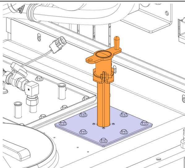
2. Percer deux trous de  $\varnothing 6$  mm à une distance de 23 mm à partir du haut de collerette du réservoir septique. Les trous doivent être opposés de  $180^\circ$  et bien alignés.
