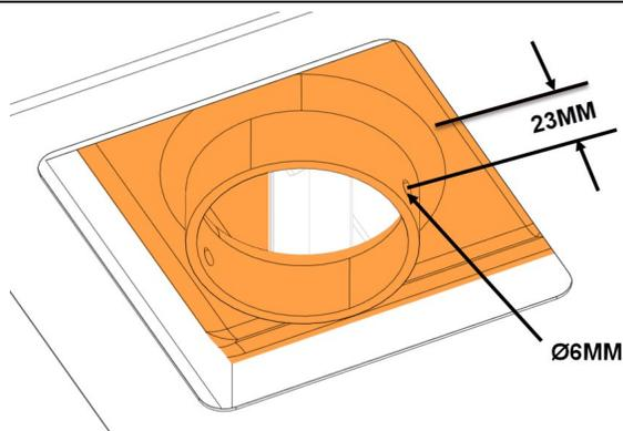
3. Installer les adaptateurs 405827 (2X) avec les vis 500557 (2x) et les rondelles plates 502556 (2x).
