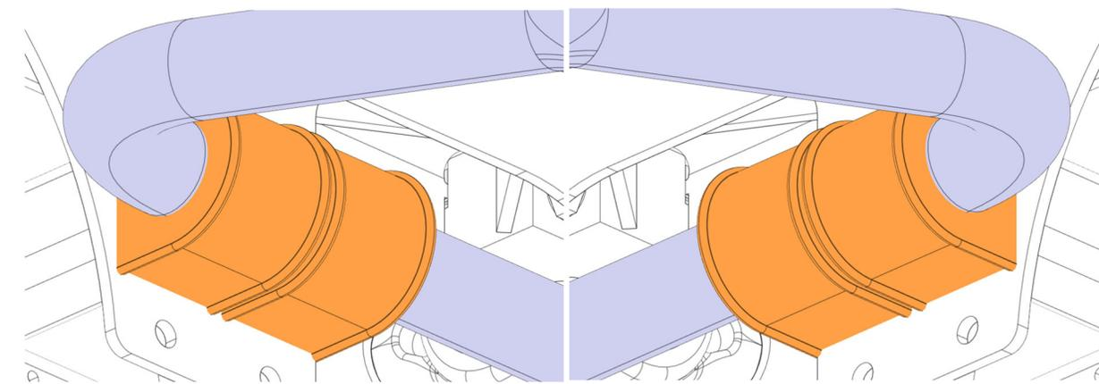
5. Installer les nouveaux collets 130076 (4x) avec les boulons 5001688 (8x), les rondelles 5002008 (8x) et les écrous 5001695 (8x).
