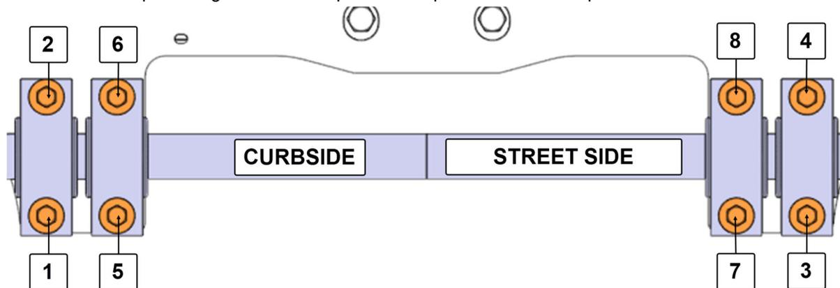
6. Effectuez le serrage final avec un couple de 90lb-pi en suivant la séquence de 1 à 8.
