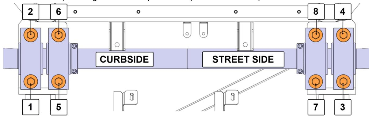
8. Effectuez le serrage final avec un couple de 90lb-pi en suivant la séquence de 1 à 8.
