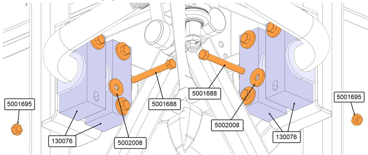
7. Effectuez le préserrage avec un couple de 60lb-pi en suivant la séquence de 1 à 8.
