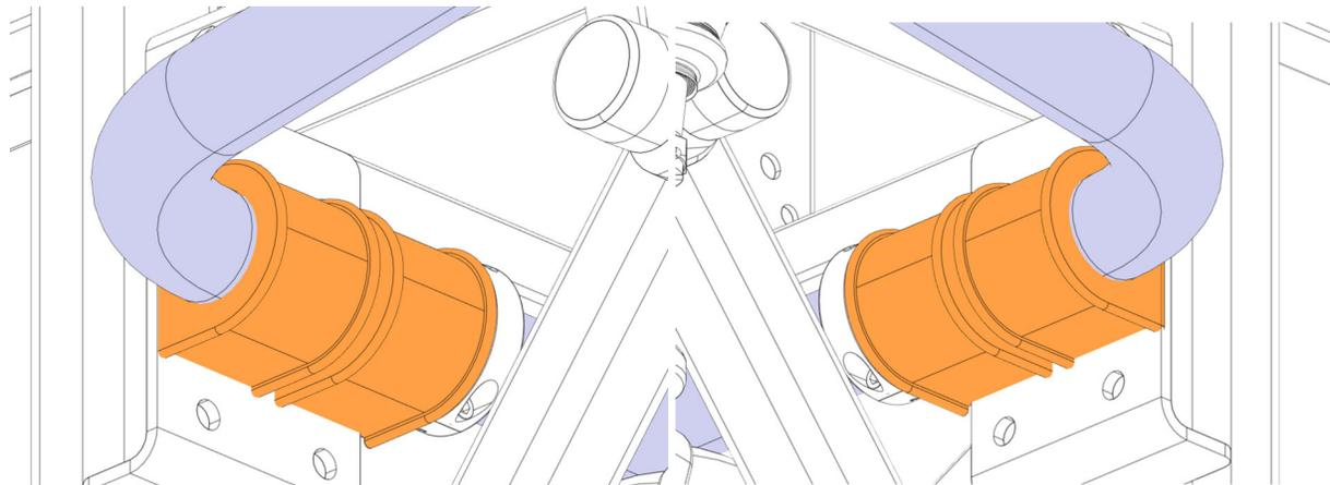
6. Installer les nouveaux collets 130076 (4x) avec les boulons 5001688 (8x), les rondelles 5002008 (8x) et les écrous 5001695 (8x).
