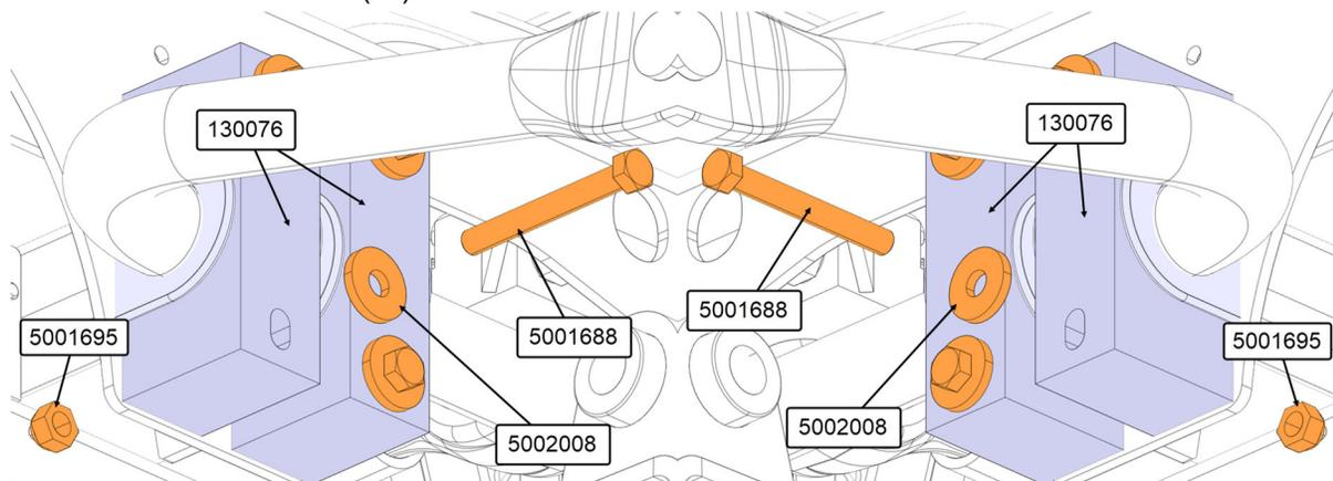
12. Effectuez le préserrage avec un couple de 60lb-pi en suivant la séquence de 1 à 8.
