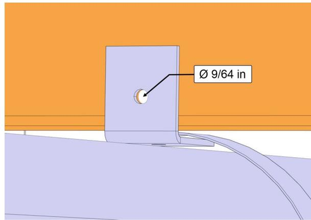
8. Fixer le support au tube de structure avec la vis 500957.
