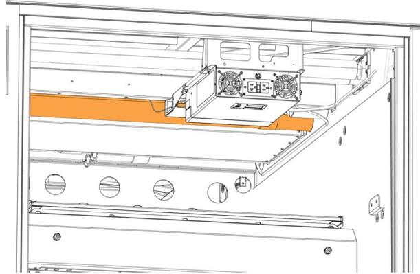
5. Localiser le tube de structure auquel sera attaché le tuyau en PVC à l'intérieur du cinquième compartiment à bagages.
