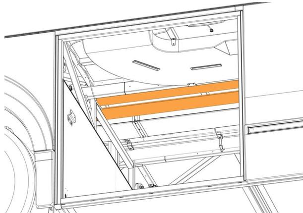
3. Localiser le tube de structure auquel seront attachés les tuyaux en PVC à l'intérieur du premier compartiment à bagages.
