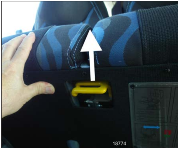
FIGURE 15: SOULÈVEMENT DE L'ASSISE
