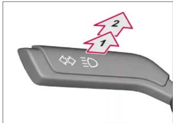
FIGURE 26: COMMANDE DES FEUX DE ROUTE
