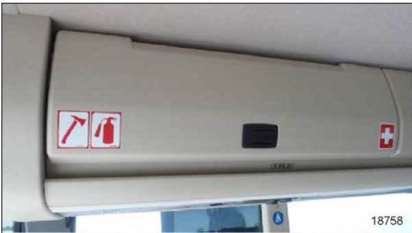
FIGURE 9: LA PRÉSENCE D'AUTOCOLLANTS INDIQUE QU'UNE HACHE D'INCENDIE, UN EXTINCTEUR ET UNE TROUSSE DE PREMIERS SOINS SONT RANGÉS DANS CE PORTE-BAGAGE À MAIN
