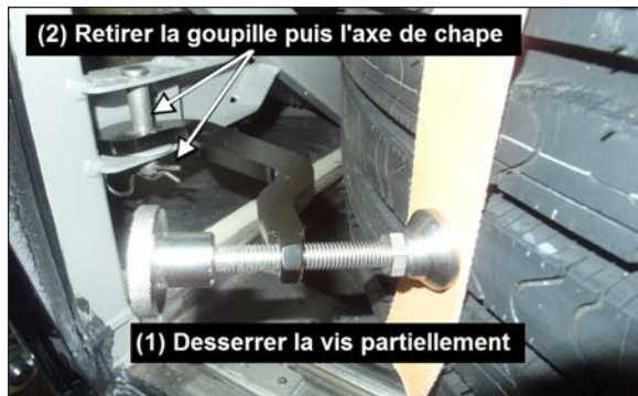
FIGURE 12: RETRAIT DE LA ROUE DE SECOURS
