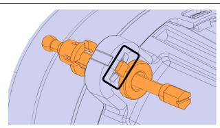
11. Installer les nouveaux phares modifiés avec le nouveau dispositif de réglage sur le support (des deux côtés).
