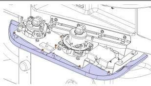
7. Débrancher le câblage et le mettre au rebut (des deux côtés).
