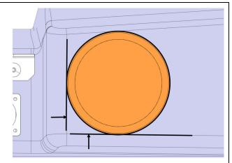
15. Utiliser une scie cloche de 3 1/2 pour percer le trou au centre de la marque du gabarit.
