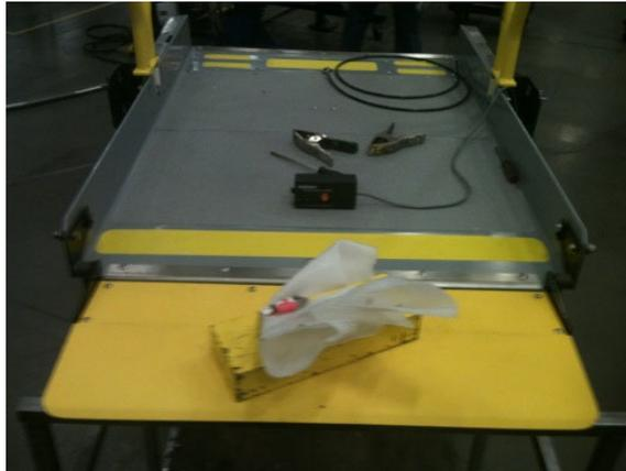
**FIGURE 2-8. 25 LB. (11 KG) LOAD TEST (CENTER SIDE)**
