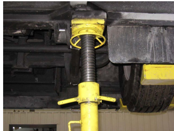
FIGURE 18: CHANDELLE AU SUPPORT DE LEVAGE - À L'ARRIÈRE DE L'ESSIEU AVANT, CÔTÉ TROTTOIR
