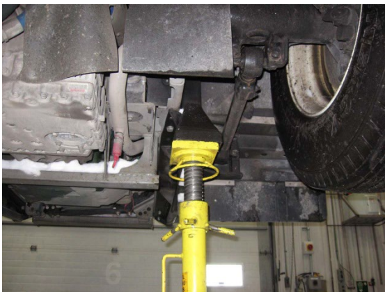
FIGURE 19: CHANDELLE AU SUPPORT DE LEVAGE - À L'ARRIÈRE DE L'ESSIEU AUXILIAIRE, CÔTÉ ROUTE
