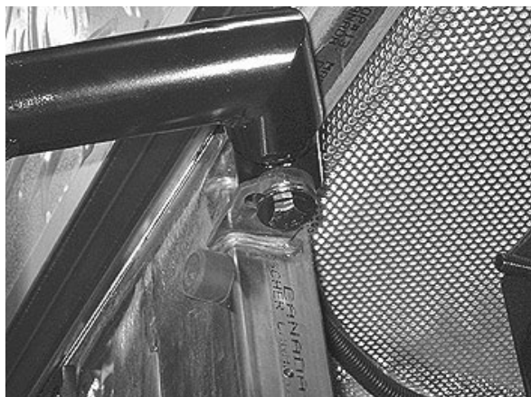
FIGURE 73: AJUSTEMENT DE LA PROFONDEUR DE LA PORTE
