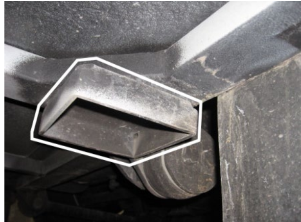
FIGURE 16: SUPPORT DE LEVAGE AU CHÂSSIS OPTIONNEL - À L'ARRIÈRE DE L'ESSIEU AUXILIAIRE
