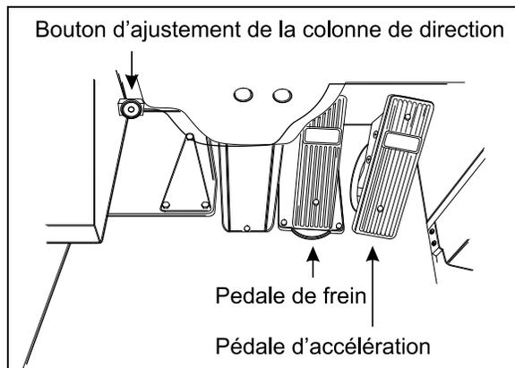
INCLINAISON ET RÉGLAGE TÉLESCOPIQUE
