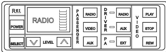
Ce système permet au conducteur de contrôler de façon indépendante le volume des haut-parleurs de sa section et de celle des passagers. Ce système permet également de gérer le fonctionnement du vidéo et des systèmes auxiliaires, tels le DVD.
