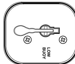
L'autocar peut être muni d'un système optionnel d'abaissement de la suspension. Ce système permet l'abaissement de l'autocar d'environ 100 mm (4 pouces) en basculant le levier à la position «LOW BUOY». Consulter le chapitre «Autres caractéristiques» pour plus de détails.
