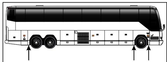
POINTS DE LEVAGE SOUS LE CHÂSSIS
