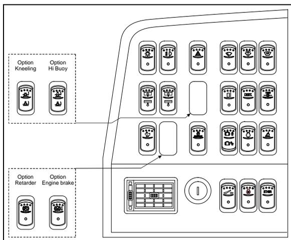
Le panneau de commande gauche du tableau de bord comprend les interrupteurs de commande pour la conduite de l'autocar. Il comprend également l'interrupteur du dispositif de démarrage à froid, le commutateur d'allumage et un registre d'air réglable pour le conducteur.
