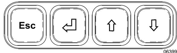
Utiliser les flèches vers le haut (↑) ou vers le bas (↓) pour mettre en évidence une fonction ou un réglage. De petites flèches apparaissent dans le coin droit supérieur ou inférieur de l'écran pour indiquer que de l'information supplémentaire est disponible en utilisant les flèches de défilement.
