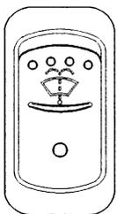
Basculer et maintenir cet interrupteur vers le bas pour actionner les lave-glaces. Les essuie-glaces sont automatiquement actionnés et s'arrêtent quelques secondes après le relâchement de l'interrupteur.
