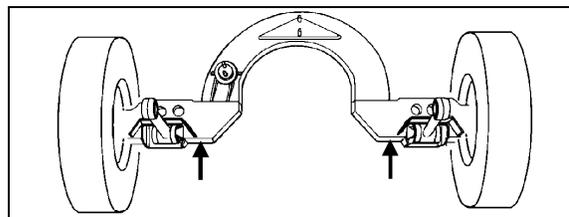
POINTS DE LEVAGE SOUS L'ESSIEU PORTEUR<sup>0EH3B764</sup>
