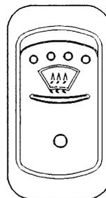
L'autocar peut être équipé d'un système de dégivrage de la partie supérieure des pare-brise. Basculer l'interrupteur vers le bas pour mettre en marche la pompe de recirculation et le ventilateur qui permet de pousser l'air réchauffé afin de désembuer, dégivrer et déglacer la partie supérieure des pare-brise.
