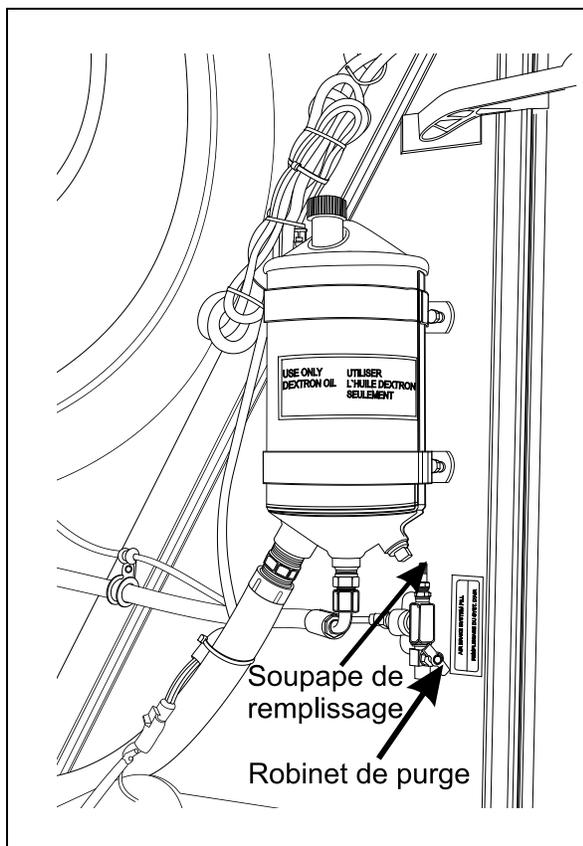
SOUPAPE DE REMPLISSAGE DU COMPARTIMENT MOTEUR
