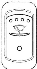
Basculer l'interrupteur vers le bas, à la première position pour commander le mode intermittent et à la deuxième pour un balayage constant.
