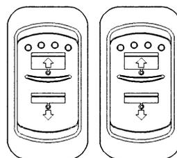
Basculer et maintenir l'interrupteur vers l'arrière pour descendre le pare-soleil gauche et vers l'avant pour le remonter. Faire de même avec le second interrupteur pour régler la hauteur du pare-soleil droit.
