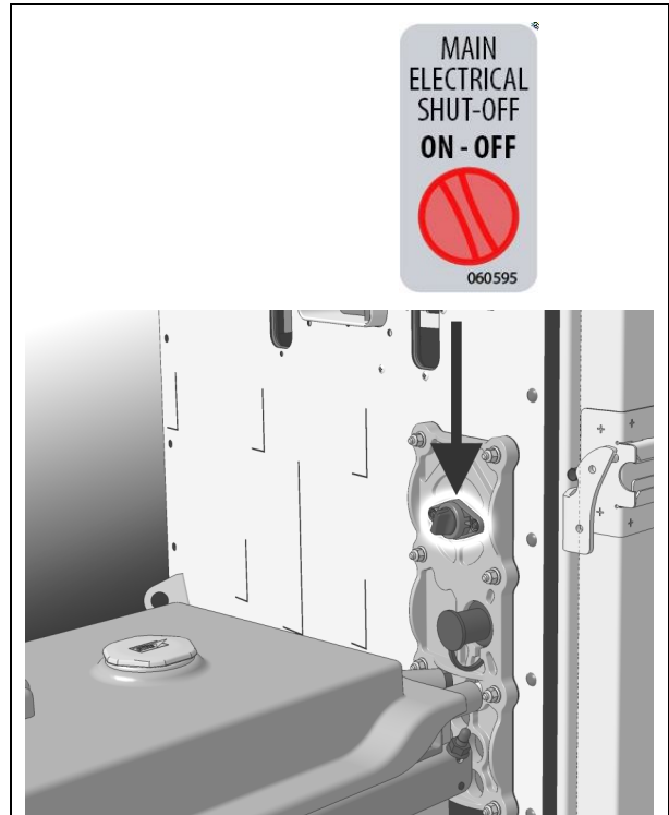
INTERRUPTEUR PRINCIPAL D'ALIMENTATION
