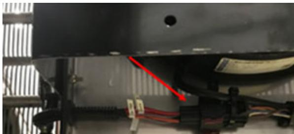
9. Connecter **PS2** à l'interrupteur pression 950270.
