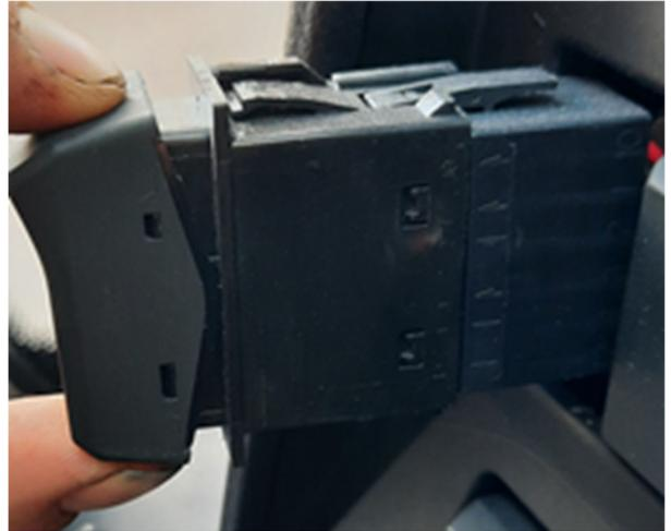
7. Appuyer sur les languettes du connecteur et retirer l'interrupteur.
