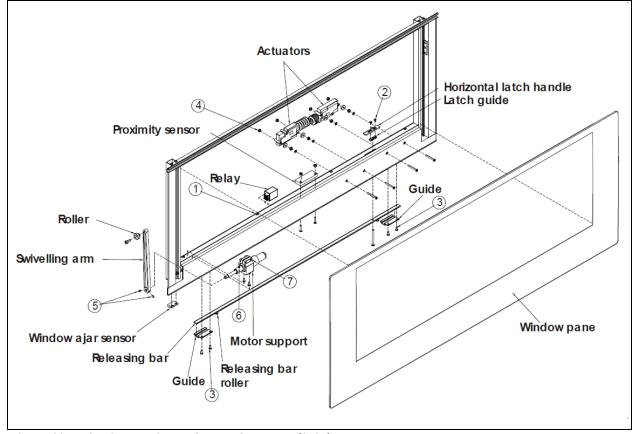
FIGURE 106: ELECTRIC AWNING WINDOW EXPLODED VIEW (SASH) 18583
