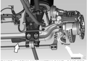
FIGURE 9: I-BEAM AXLE HOISTING POINT - ROAD SIDE
