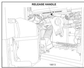
FIGURE 99: FRONT BUMPER RELEASE HANDLE
