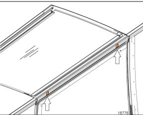
FIGURE 43: EXTRUSION LOCK LOCATION
