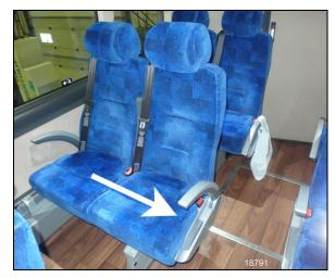
FIGURE 89: PULL TO UNLOCK THE ROTATION
