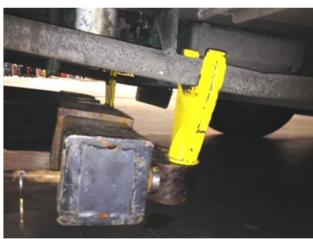
FIGURE 62: PROPER LOCATION WHEN LIFTING THE SIDE MEMBERS
