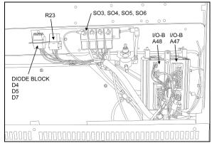
FIGURE 21: ENTRANCE DOOR & WIPER CONTROL PANEL
