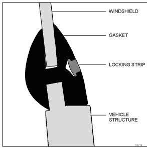
FIGURE 19: WINDSHIELD INSTALLATION SIDE VIEW
