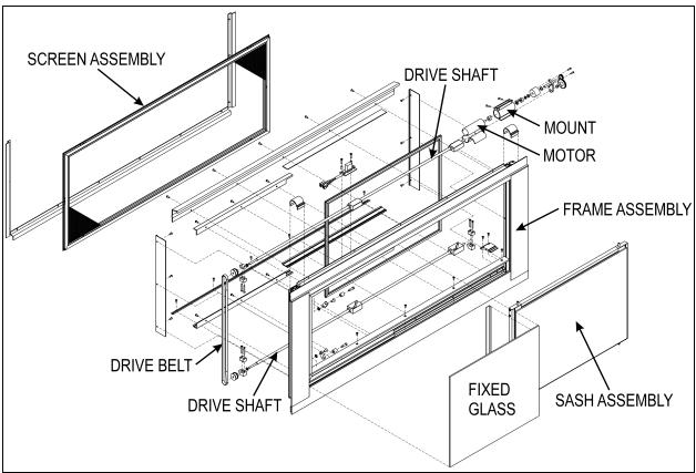
FIGURE 107: ELECTRIC SLIDING WINDOW EXPLODED VIEW
