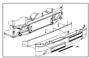
FIGURE 98: FRONT BUMPER REMOVAL
