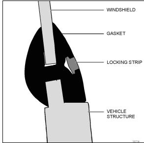
FIGURE 102: WINDSHIELD INSTALLATION SIDE VIEW
