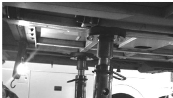
FIGURE 37: CHANDELLES SOUS LE SUPPORT DU RESERVOIR DE CARBURANT
