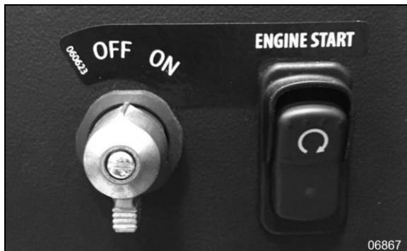
FIGURE 65: AGENCEMENT DES COMMUTATEURS AVEC UN MODULE DE DÉMARRAGE
