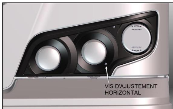
FIGURE 74: MODULES D'ÉCLAIRAGE
