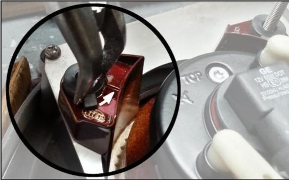
FIGURE 83: VERROUILLER LES TIGES FILETÉES
