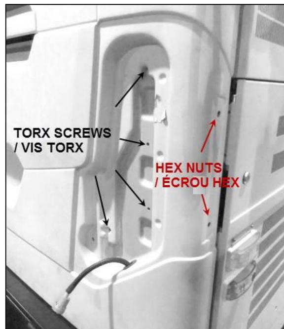
FIGURE 108 : VIS DE FIXATION ET ÉCROUS DU MODULE DES FEUX ARRIÈRE
