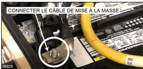
FIGURE 59: CâBLE DE MISE À LA MASSE
