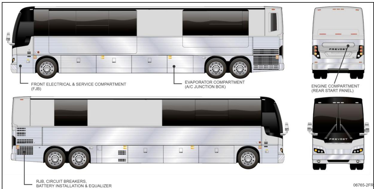
FIGURE 18 : COMPARTIMENTS ÉLECTRIQUES (X3-45 VIP)
