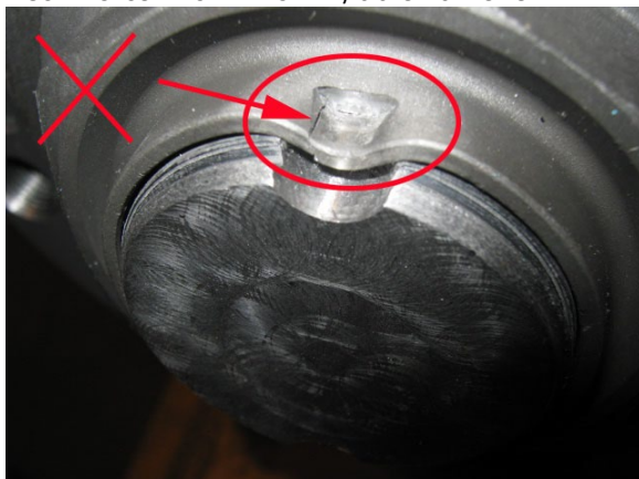
FIGURE 26: CREUX BRISÉ OU DÉCHIRÉE - REJETÉ
