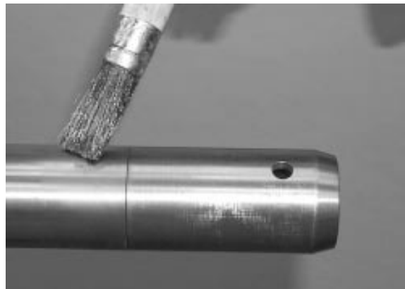
FIGURE 19 : APPLIQUER LA GRAISSE GLEITMO 805
