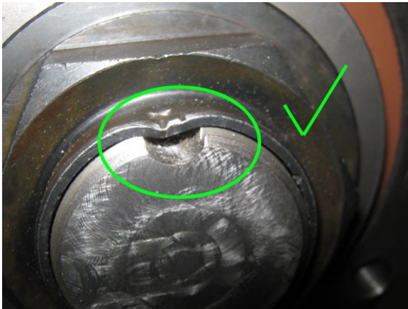
FIGURE 24: CORRECT - EMPÊCHE L'ÉCROU DE SE DESSERRER
