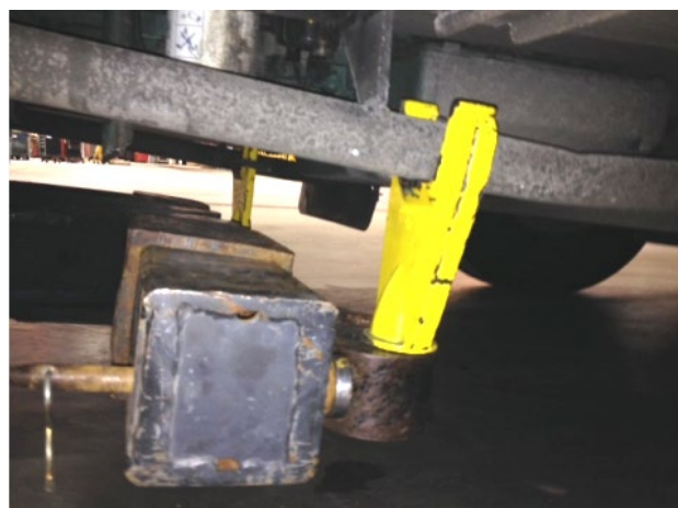
FIGURE 62: EMBLACEMENT RECOMMANDÉ POUR LE LEVAGE PAR LES LONGERONS.
