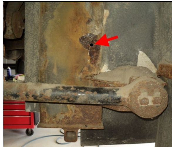
FIGURE 7: TROU PERCÉ DANS LE CHÂSSIS
