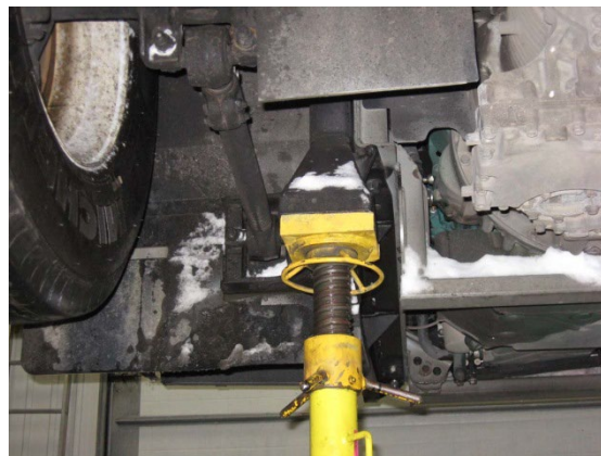
FIGURE 21: CHANDELLE AU SUPPORT DE LEVAGE - À L'ARRIÈRE DE L'ESSIEU AUXILIAIRE, CÔTÉ TROTTOIR
