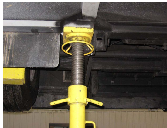
FIGURE 4: CHANDELLE AU POINT DE LEVAGE DU CHÂSSIS - À L'ARRIÈRE DE L'ESSIEU AVANT
