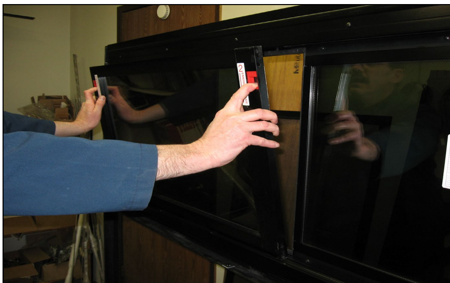
FIGURE 102: RETRAIT DU CHÂSSIS
