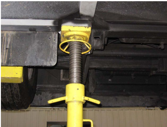
FIGURE 18: CHANDELLE AU SUPPORT DE LEVAGE - À L'ARRIÈRE DE L'ESSIEU AVANT, CÔTÉ ROUTE
