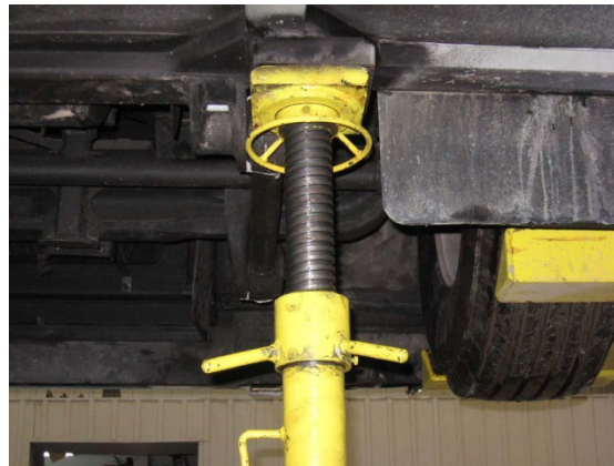
FIGURE 19: CHANDELLE AU SUPPORT DE LEVAGE - À L'ARRIÈRE DE L'ESSIEU AVANT, CÔTÉ TROTTOIR
