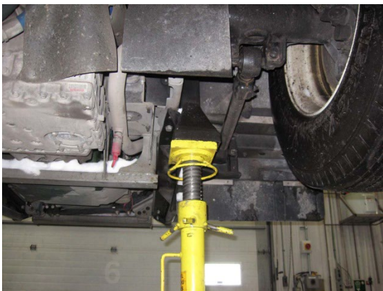
FIGURE 20: CHANDELLE AU SUPPORT DE LEVAGE - À L'ARRIÈRE DE L'ESSIEU AUXILIAIRE, CÔTÉ ROUTE
