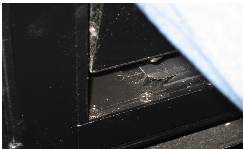
FIGURE 50: POSITIONNEMENT DE L'ANGLE INFÉRIEUR GAUCHE DU CHÂSSIS
