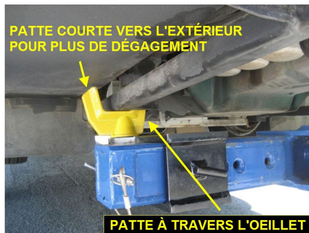
FIGURE 63: EMPLACEMENT RECOMMANDÉ POUR LE LEVAGE PAR LES LONGERONS – VÉHICULE AVEC OEILLETS DE REMORQUAGE ARRIÈRE
