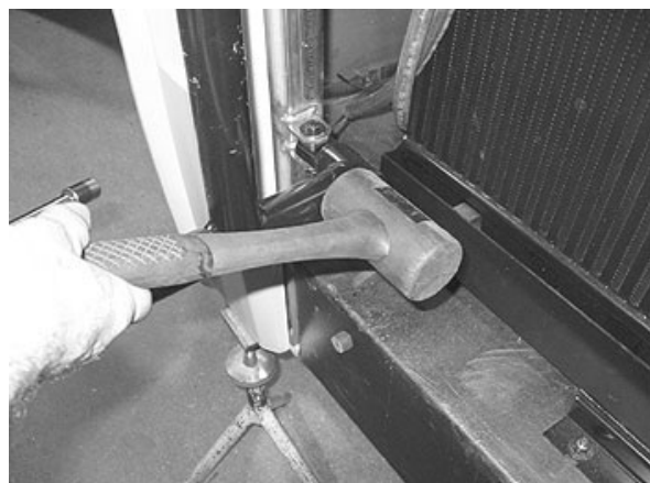
FIGURE 69: RÉGLAGE DE BRAS DE PANTOGRAPHE
