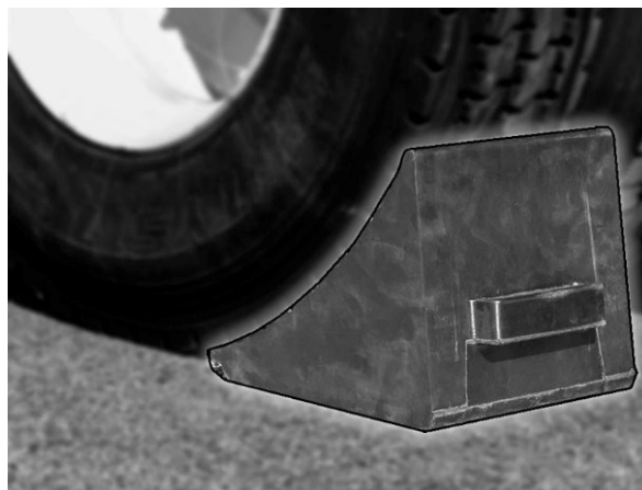
FIGURE 22 : CALER LES ROUES AVANT ET ARRIÈRE
