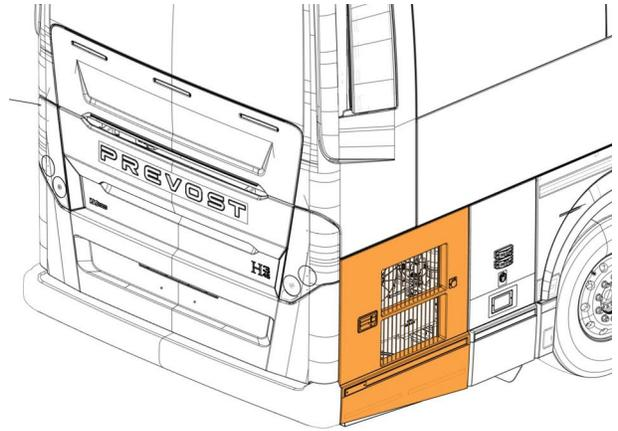
2. Soulever le levier pour déverrouiller la porte du compartiment moteur.
