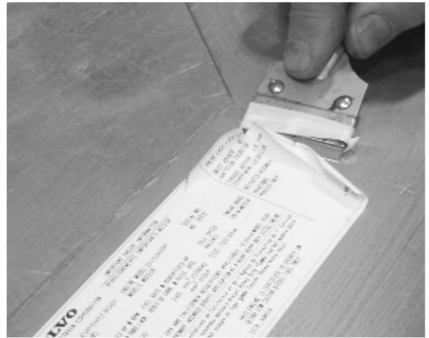
8. Apposer soigneusement le nouvel autocollant des renseignements moteur au même endroit.
