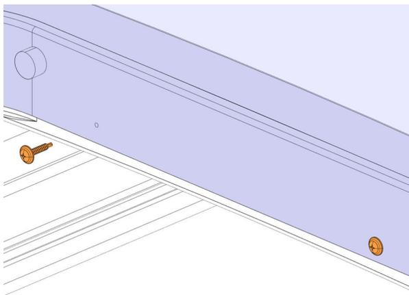
10. Réinstaller le couvercle sur le cadre de la trappe.
