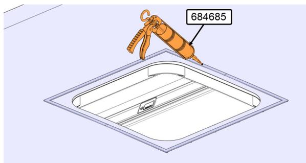
5. Installer le cadre de la trappe sur le toit
