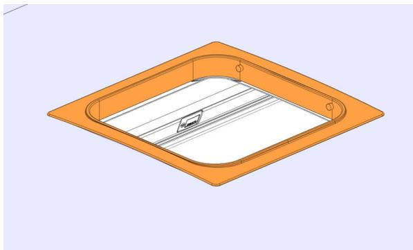
6. Fixer le cadre de la trappe avec des pinces (8x) et utiliser un morceau de bois entre la pince et la finition du toit et du plafond comme protection. Les pinces doivent rester en place pendant trois heures.
