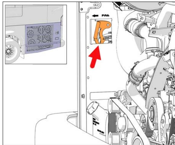
**FIGURE 26: RADIATOR DOOR LATCH RELEASE LEVER LOCATION**
