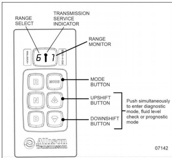
FIGURE 56: ALLISON PUSHBUTTON SHIFT SELECTOR
