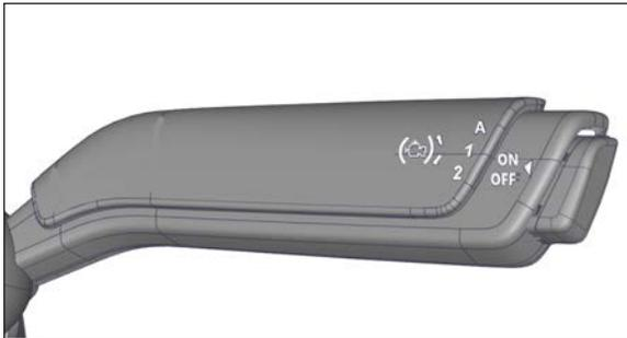
FIGURE 30: ENGINE BRAKE CONTROL STALK
