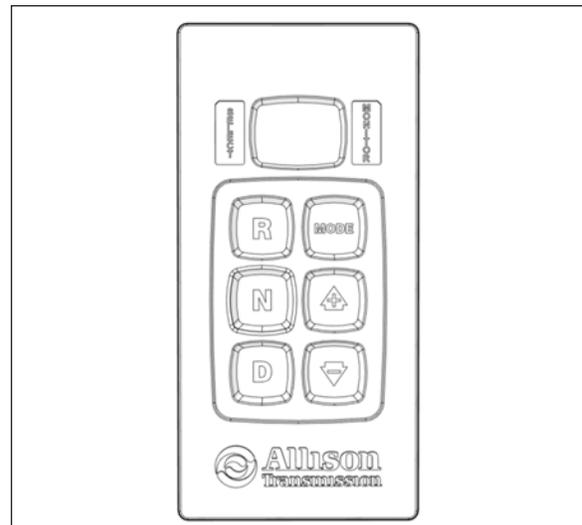
FIGURE 8: TRANSMISSION CONTROL PAD
