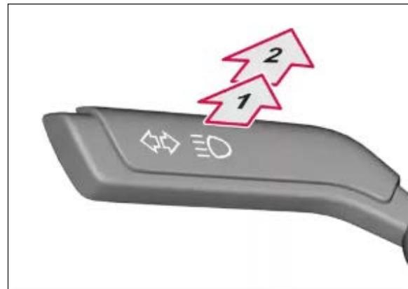
FIGURE 27: HIGH BEAM CONTROL
