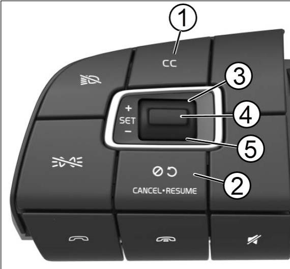
**FIGURE 45: CRUISE CONTROL BUTTONS**
