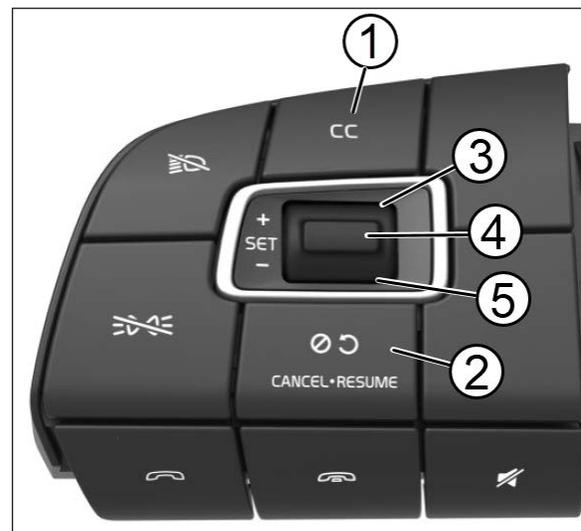
FIGURE 39: CRUISE CONTROL BUTTONS
