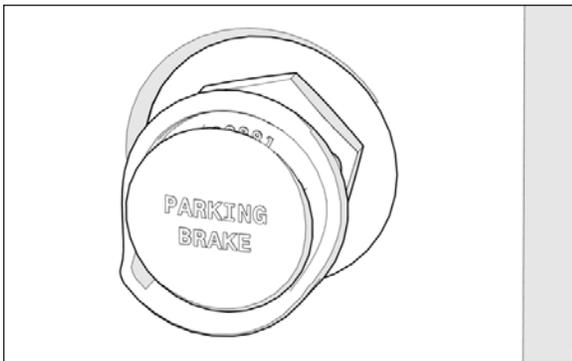
FIGURE 14: PARKING BRAKE CONTROL KNOB
