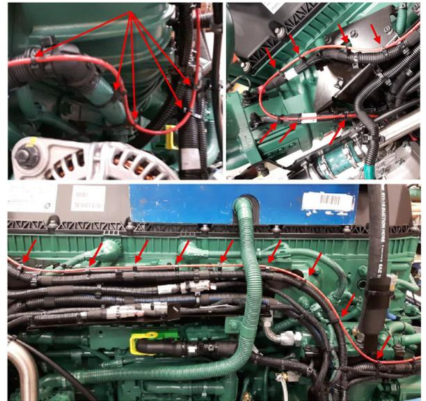
10. Déconnecter le câble LTD du connecteur C39A situé à l'arrière du moteur.
