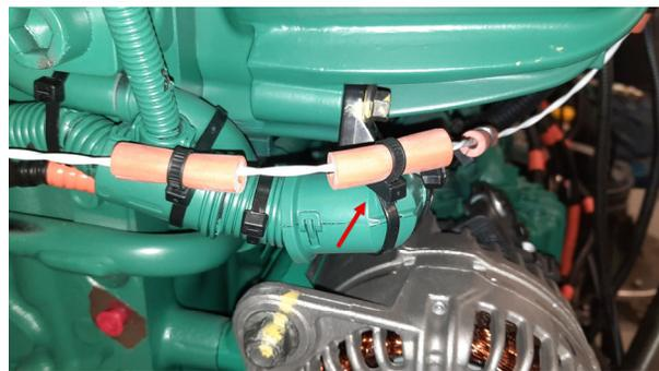
19. Acheminer le LTD vers le haut sur le support du câblage du moteur, en veillant à ce que le diamètre de courbure soit au minimum de 6 pouces. Utiliser des grommets 504300 et des attaches-câbles à double boucle 507664.
