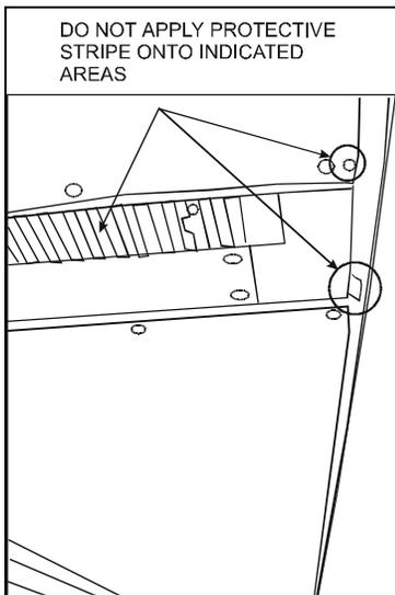
FIGURE 2 : UNDERNEATH SLIDE-OUT
