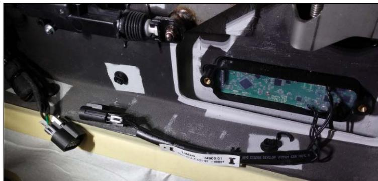
10. Brancher le harnais de clavier sur le faisceau du véhicule et le bloquer en position (patte grise). Un signal sonore se fait entendre lorsque le clavier est rebranché. Fixer le connecteur sur le châssis de porte à l'aide d'une attache de câble de taille moyenne.
