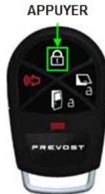
11. Recommencer (appuyer sur le bouton de verrouillage) avec chaque émetteur à programmer (jusqu'à 20 émetteurs peuvent être programmés).
