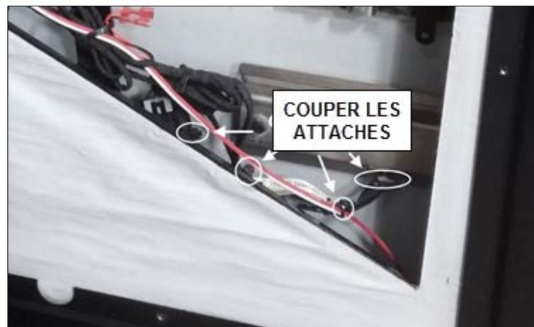
19. Débrancher le harnais du clavier (débloquer d'abord le connecteur en faisant coulisser la patte grise vers le haut).
