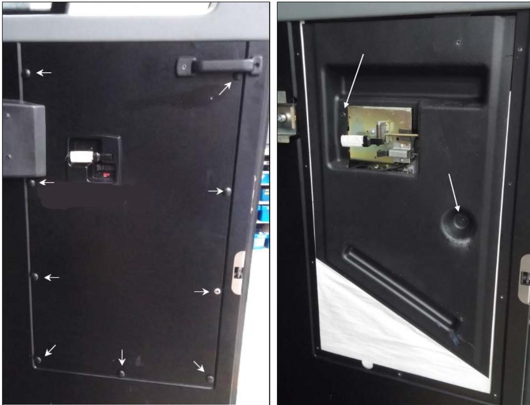
18. Repérer le couvercle arrière du clavier et couper la petite attache de câble maintenant le faisceau du clavier sur le couvercle arrière. Couper également toutes les attaches de câble maintenant le harnais de clavier et le connecteur au châssis et au harnais de porte.
