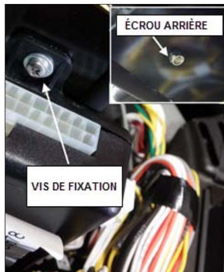
4. Retirer le module du support (lever pour dégager l'agrafe inférieure du module) et débrancher les connecteurs latéraux du module.
