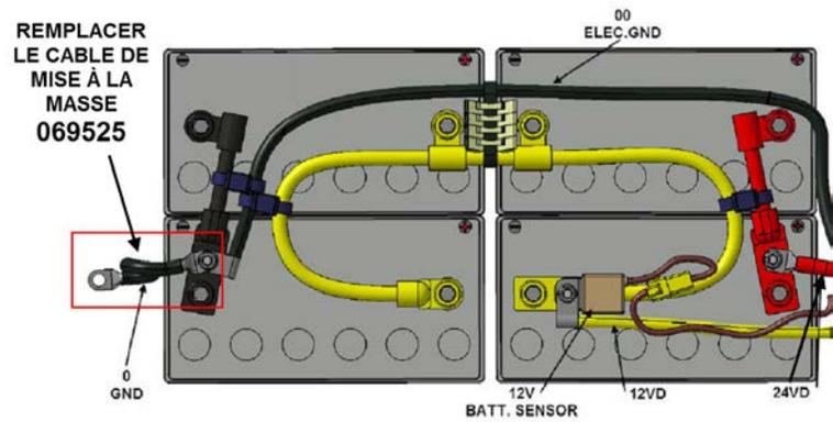
3. Débrancher le câble à la borne de la batterie et au châssis. Retirer le câble du véhicule.
