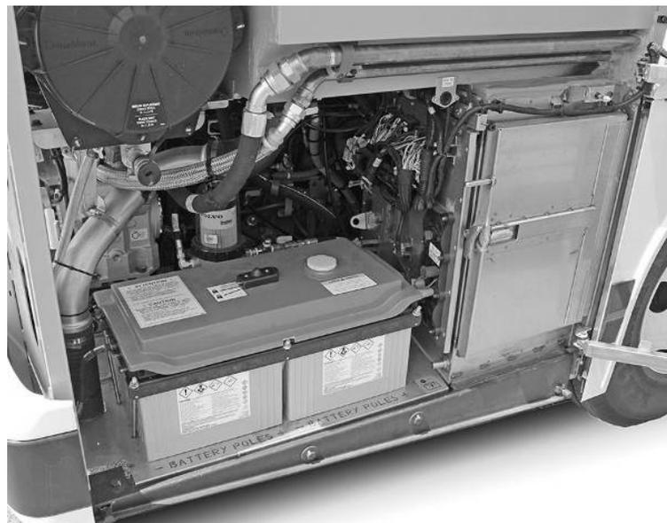
2. Repérer le câble de mise à la masse **069525** branché au châssis (côté gauche; voir l'image ci-contre).
