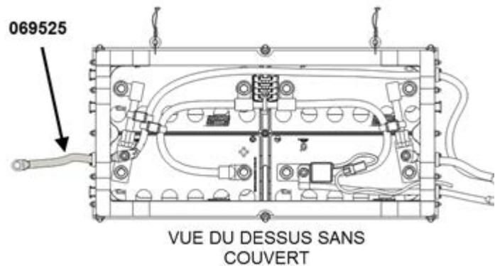
5. Fixer le câble à la batterie et au châssis. Appliquer un couple de serrage de **170 lb-po.**
