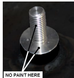
FIGURE 61 : BORNE DE MASSE #380360
