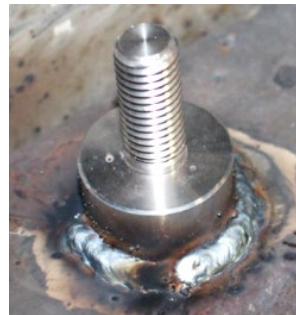
FIGURE 60 : BORNE DE MASSE #380360
