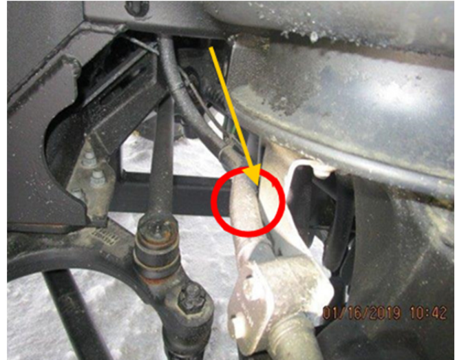
FIGURE 3 : IL Y A UN RISQUE DE FROTTEMENT À L'ENDROIT IDENTIFIÉ
