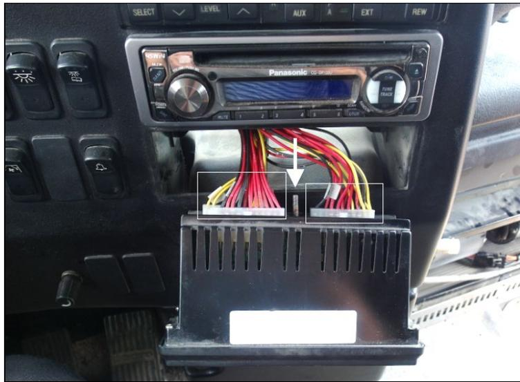
3. Brancher les deux relais **563332** aux connexions RFD1 et RFD2 du harnais d'interface.
