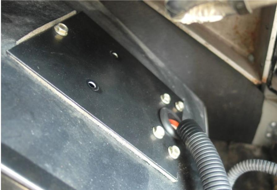
18. Brancher le contrôleur au moteur(s) de soufflerie. Les installations à un seul moteur doivent utiliser l'adaptateur **0600037**.
