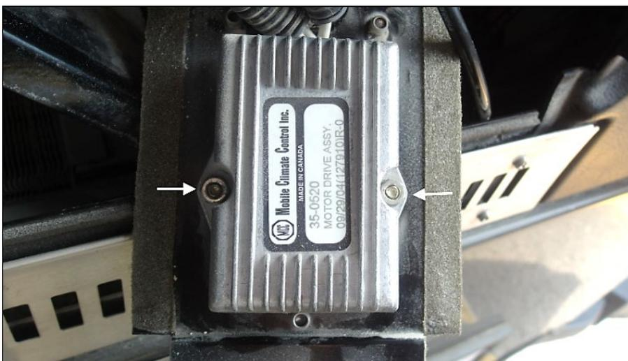
14. Débrancher les trois autres connecteurs du contrôleur et disposer de celui-ci.
