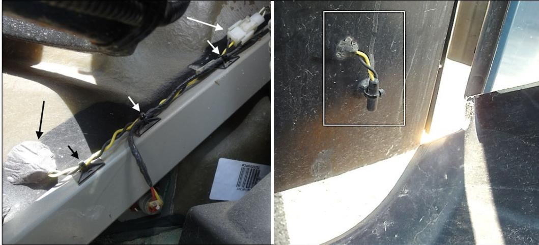
22. Installer le nouveau capteur de température extérieure **563335**.
