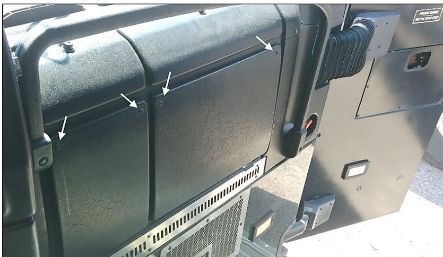
10. Retirer le couvert de la soufflerie pour accéder au(x) moteur(s) et au contrôleur de soufflerie (contrôleur MCC pour HVAC).
