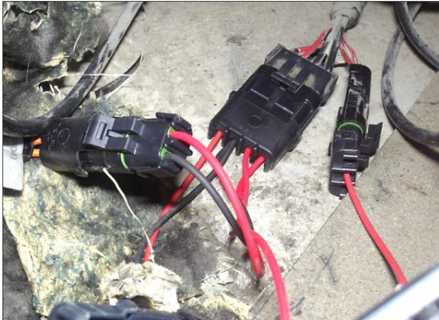
21. Retirer le capteur de température extérieur du véhicule (un véhicule de série X est illustré ci-dessous, les véhicules de série H diffèrent légèrement).
