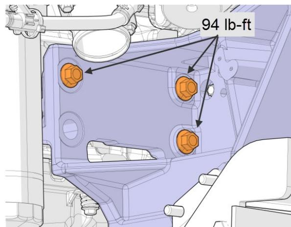
FIGURE 58: TROIS (3) VIS SUR LE CÔTÉ DU SUPPORT DE MOTEUR
