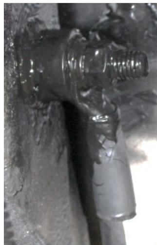
FIGURE 128 : BORNE DE MASSE AVEC REVÊTEMENT DE CAOUTCHOUC
