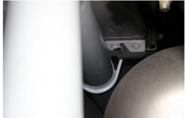
FIGURE 101: SUPPORT DE TUYAU D'ADMISSION DU MOTEUR
