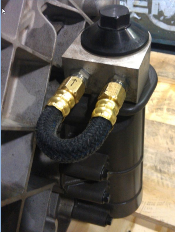
FIGURE 4: VOLVO 9700 - BOUCLE DE CIRCULATION D'HUILE
