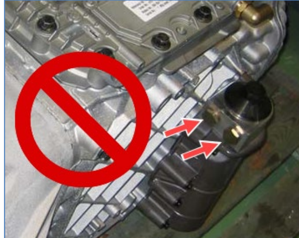
Figure 5: NE PAS BOUCHER LES ORIFICES DANS LA PARTIE SUPÉRIEURE DU BOITIER DU FILTRE
