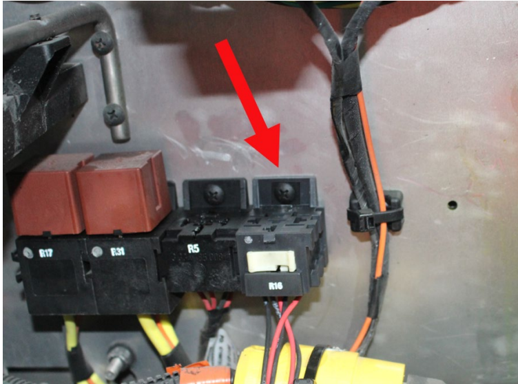
FIGURE 28: BASE DE RELAI ET RELAI R16 UNE FOIS INSTALLÉS
