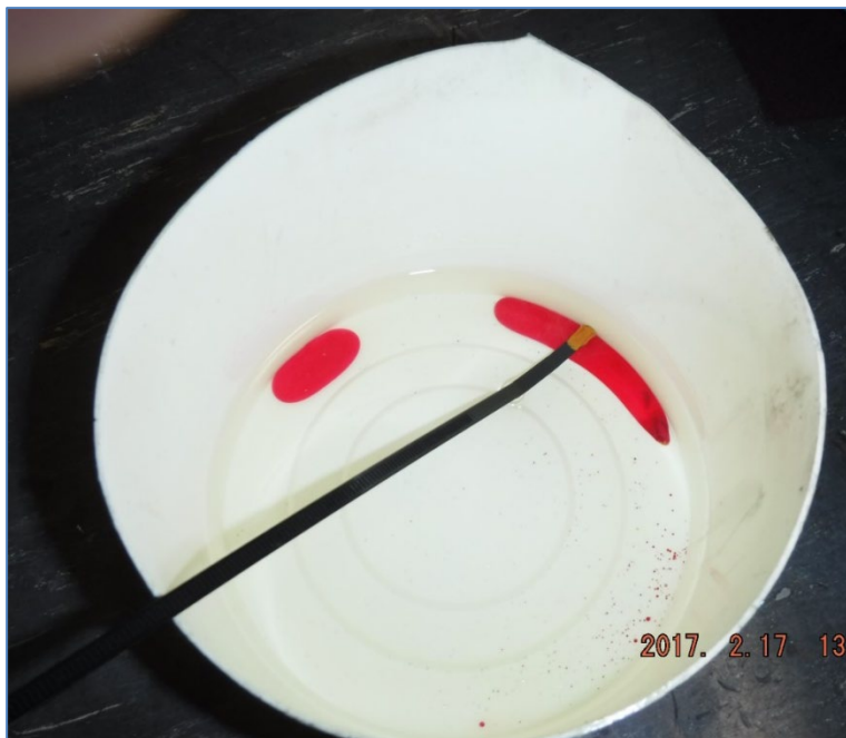
FIGURE 3: ÉCHANTILLON DE CARBURANT CONTENANT DU DEF QUI TOURNE AU ROUGE
