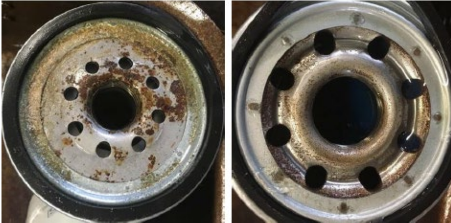
FIGURE 4: ACCUMULATION DE CRISTAUX ET DE CORROSION SUR LA FACE DU PRÉFILTRE. CORROSION SUR LA FACE DU FILTRE PRINCIPAL
