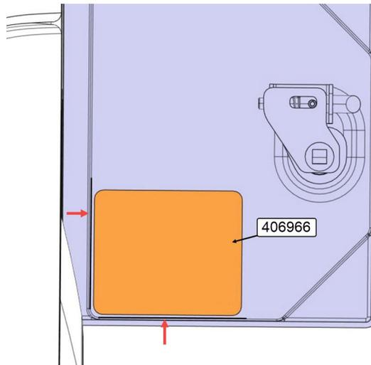
6. Ouvrir la porte à carburant côté gauche et repérer le décalque de capacité du réservoir.
