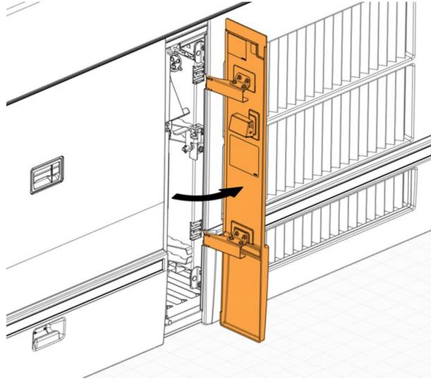
2. Retirer l'ancien décalque de capacité du réservoir.
