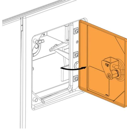
2. Retirer l'ancien décalque de capacité du réservoir.
