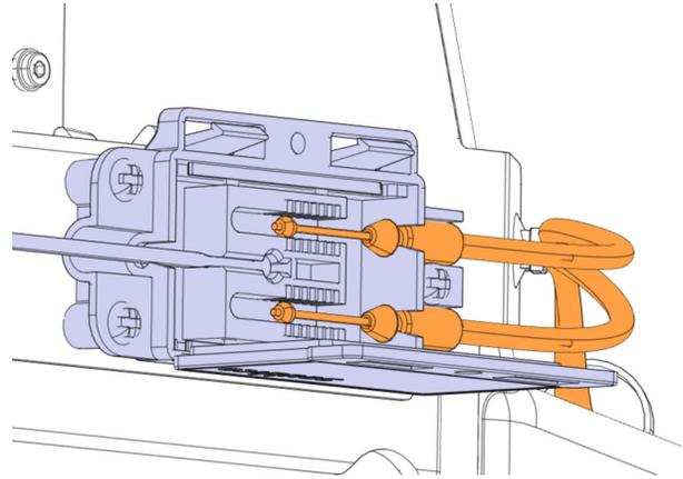
5. Fixer les câbles à l'aide des deux clips. Ne pas trop serrer les clips sur les câbles.
