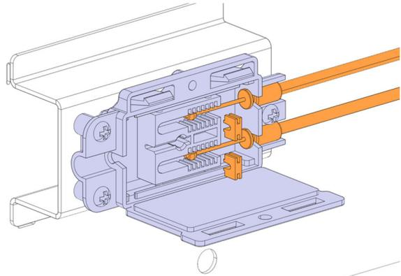
9. Retirer le répartiteur et les vis (3x). Conserver le répartiteur et les vis pour les réutiliser.
