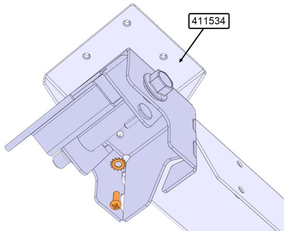
2. Réinstaller le répartiteur sur le nouveau support 411534 à l'aide de trois vis (3x).
