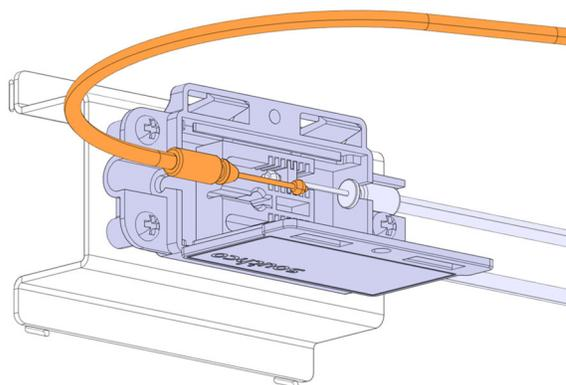
8. Retirer les clips (2x) puis retirer les deux câbles des loquets de porte.
