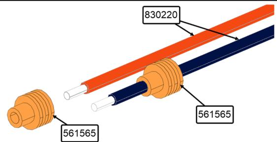
2. Sertir les terminaux 561567 (2x) sur les joints d'étanchéité et sur les fils de la lampe 830220.
