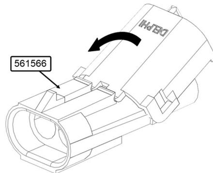
4. Insérer les terminaux à l'intérieur du connecteur 561566, le fil noir en position **A** et le fil rouge en position **B**.
